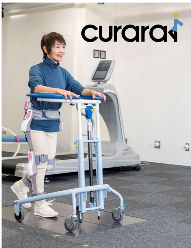
curara®は、加齢や事故、病気などによって歩行が難しくなった方のための歩行を教えてください。人とロボットがお互いにリズムを合わせることで、歩行の仕方を学びます。重量はわずか 2.7Kg と圧倒的に軽く、女性でも使いやすいデザインとなっています。簡易版の2関節、強化版の4関節の2種類があり、自分に合ったロボットをお選びいただけます。専用のモバイルでは操作や歩行の記録がとれるので、自分の歩行状態を確認することができます。
